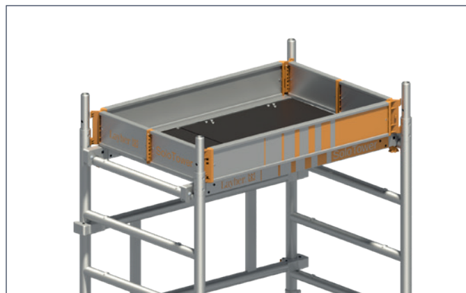
4. Bordbretteinheit 12 an den gegenüberliegenden Holmen anlegen
