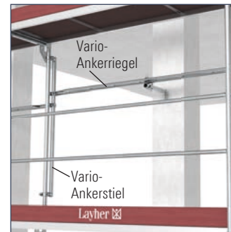
Bild 61: Vario-Anker-System für freies Platzieren des Ankers im Feld
