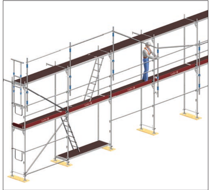
Bild 44: Umsetzen des Montage-Sicherungs-Geländers von der gesicherten Lage aus
