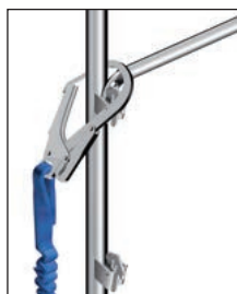
Bild 8: Anschlagpunkt 3 (Nur zulässig mit Layher Anschlaghaken)
