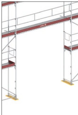
Bild 115: Überbrückung mit 4,14 m Stahlboden LW
