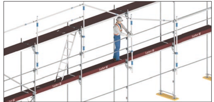
Bild 23: Anwendung des Montage-Sicherungs-Geländers in der Gerüstlage
