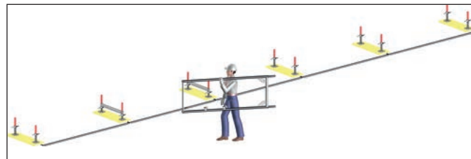
Bild 38: Auslegen der untersten Gerüstlage
