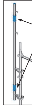
Bild 17: Anschluss Montagepfosten am Vertikalstiel
