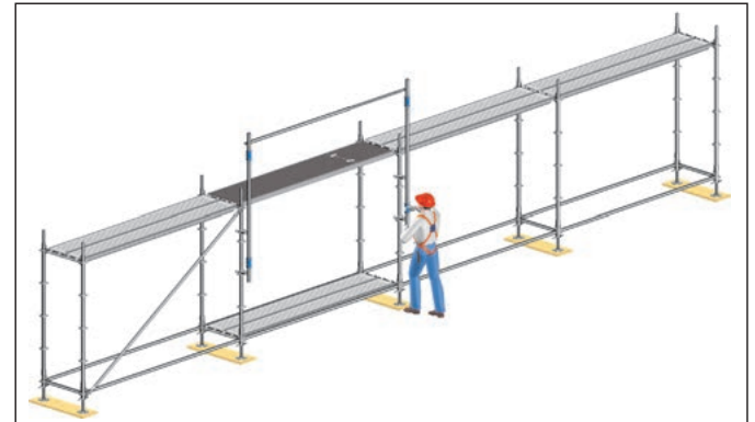
Bild 18: Anwendung des MSG im Aufstiegsfeld
