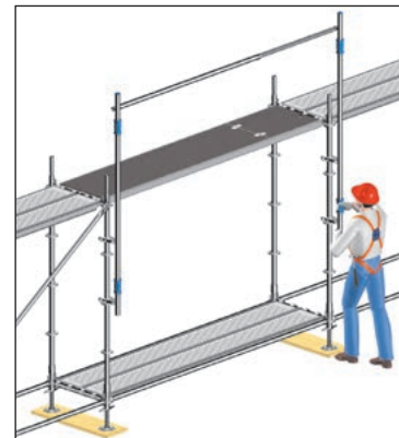
Bild 19: Detail der Montage des MSG im Aufstiegsfeld
