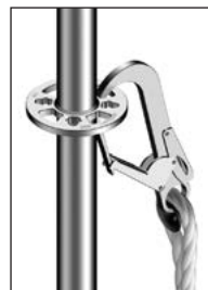
Bild 10: Anschlag im großen und kleinen Loch der Lochscheibe möglich (Nur zulässig bei AllroundGerüst aus Stahl – nicht bei Aluminium)
