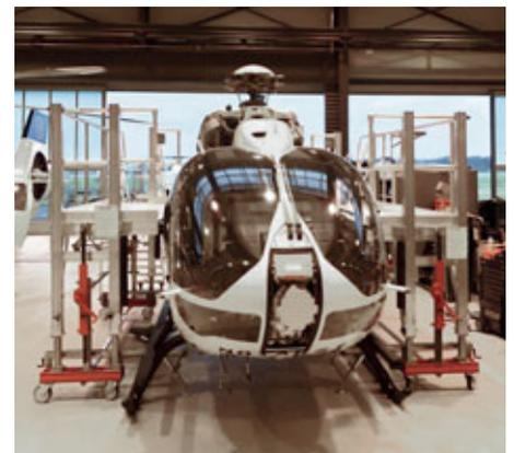
Mobile Hubschrauberbühne mit Variotreppe als schnell einsatzbereite Wartungseinheit
