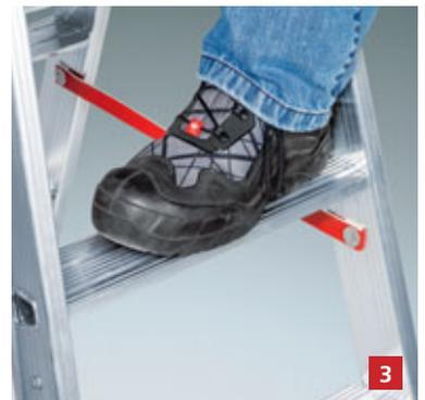
Die PREMIUM-Line und WORK-Line Stufenleitern (3) haben hochfest verbördelte Stufen-/Holmverbindungen mit 80 mm tiefen, profilierten Stufen für einen sicheren Aufstieg und ermüdungsfreien Stand, der Stufenabstand beträgt 250 mm.
