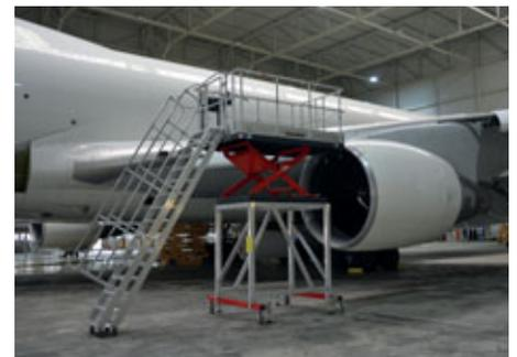
Hydraulisch höhenverstellbare Wartungsbühne
