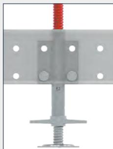
Der **TwixBeam Stopper 7** wirkt entgegen der Hangabtriebskraft der schwenkbaren TwixBeam Spindel bei geneigten Konstruktionen außerhalb des Lochrasters des TwixBeams. Der Stopper wird einfach mit Bolzen und Sicherungsstecker mit dem TwixBeam verbunden.
