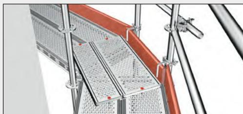
Jede Bohle ist an jedem Auflager durch zwei Kunststoff-Rastzapfen gegen Verschieben und Abheben zu sichern. Werden Sicherungsschrauben **3** verwendet, genügt eine Schraube pro Auflager.
