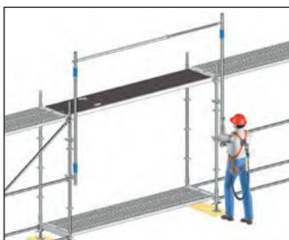
Das Montage-Sicherungs-Geländer kann am Aufstiegsfeld oder über mehrere Felder angewandt werden.
