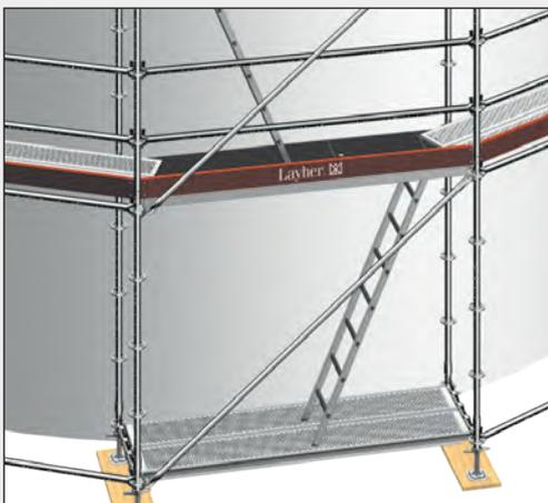
Einbausituation U-Robust-Durchstieg mit versetztem Deckel **15**
