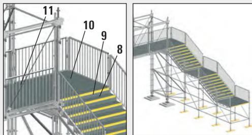
Die Setzstufen und die Abdeckungen entsprechen dem Rutschsicherheitswert R13 nach DIN EN 51130.
