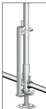
Die **Spindelbefestigung**, mit Keilkopf **6** dient zur Sicherung der Fußspindel und des Anfangsstückes gegen Herausfallen beim Umsetzen von Gerüsten mit Kran.
