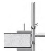
Beim Einbau an Decken sind Bordbretter vorzusehen, der Vertikalholm ist über die Spindel zu stecken.
