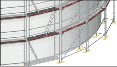
Der **U-Riegel LW, 0,73 m, 15° – 44°, SW 19 3** ermöglicht kleine Winkel in großen Rundrüstungen.
