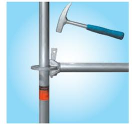
Festschlagen des Keiles sichert den Kraftschluss (Prellschlag mit einem mindestens 500 g schweren Metallhammer).
