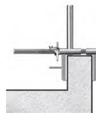
Beim Einbau an der Attika sind keine Bordbretter notwendig, der Vertikalholm ist über den Rohrverbinder zu stecken.
