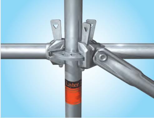
**Stiele** sind aus feuerverzinktem Stahlrohr und aus Aluminiumrohr, D=48,3 mm, erhältlich, mit Lochscheiben alle 50 cm für maximal acht Anschlüsse. Vier kleine Aussparungen in der Lochscheibe geben rechtwinklige Anschlüsse vor, vier größere Aussparungen lassen Anschlüsse in beliebigen Winkeln zu.
