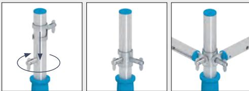
Mit dem **Kippstiftadapter 7** können an einem Montagepfosten zwei Geländer im 90°-Winkel zueinander montiert werden. Dadurch können mit dem Montage-Sicherungs-Geländer verschiedene Aufbauvarianten, insbesondere Innen- und Außenecken, gelöst werden.
