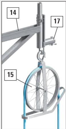
**Konsole 14** mit **Aufzugsrad 15** für den manuellen Höhentransport von Gerüstmaterial bis max. 50 kg. Zusätzlich in das Gerüst eingebrachte Lasten müssen durch besondere Maßnahmen in das Bauwerk oder in den Boden abgeleitet werden, u. a. sind zusätzliche Verankerungen erforderlich.
