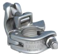
Zur rechtwinkligen Verbindung von Rohren mit D=48,3 mm – Achsmaß 53,5 mm.
