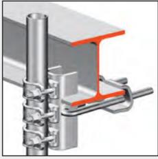
Die Einhängung der **Hängegerüstkupplung 1** erfolgt in vorhandene Winkel-, U- oder I-Profile. Sie haben durch die drei angeieteten Halbkuppelungen (für Gerüstrohre 48,3 mm) eine zulässige Belastung von 15 kN. Die
