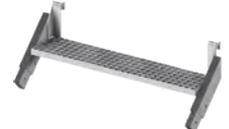
Höhenunterschiede von 0,60 m bis 1,60 m können überbrückt werden. Belastung: 3,0 kN/m<sup>2</sup>. Ausführung: Stahl feuerverzinkt. Verbindung der Treppenelemente mit Bolzen 12 x 55 mm und Sicherungsstecker 2,8 mm (2 Stück je Stoß). (Diese sind im Lieferumfang des Kopf- und des Mittelelements bereits enthalten).
