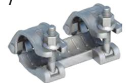
Zur Verbindung von zwei Rohren mit D=48,3 mm in einer Achse. Nur in Verbindung mit Zentrierbolzen Pos. 8.
