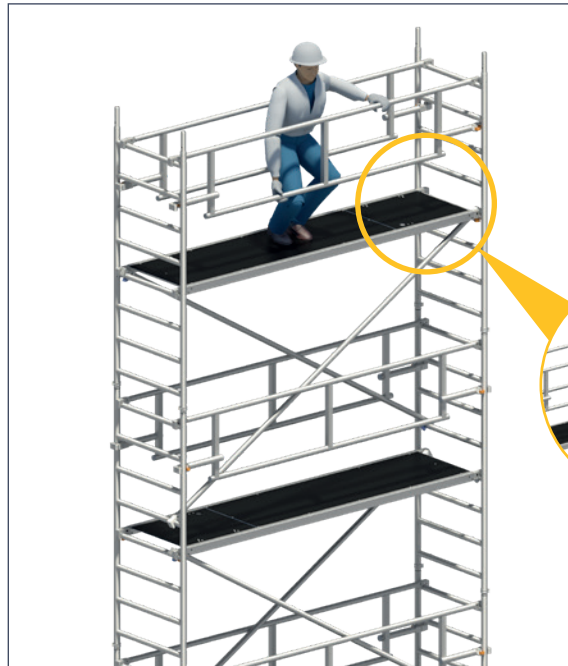
4 Aufstieg in die bereits gesicherte Lage und finales Einrasten des Doppelgeländers (untere Einrastklauen) in die Standleiter.
