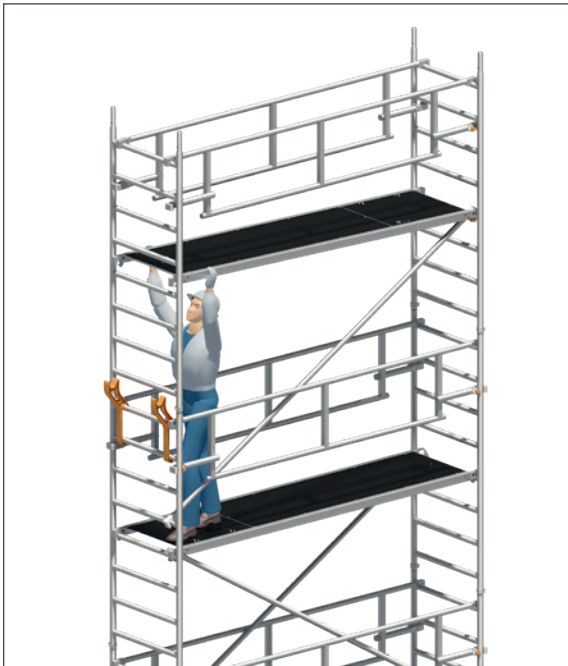
3 Diagonalen und Durchstiegsbrücke einsetzen.
