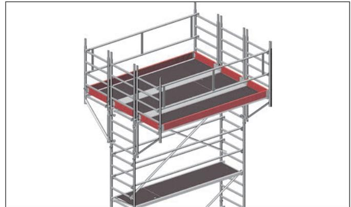
5. Auf die Konsole 0,75 m wird je eine 1,00-m-Standleiter aufgesteckt, an denen dann der zuvor demontierte Seitenschutz auf 1 m Höhe montiert wird. Anschließend kann das noch am Gerüst verbliebene Geländer auf der Höhe von 0,50 m eingebaut werden.
