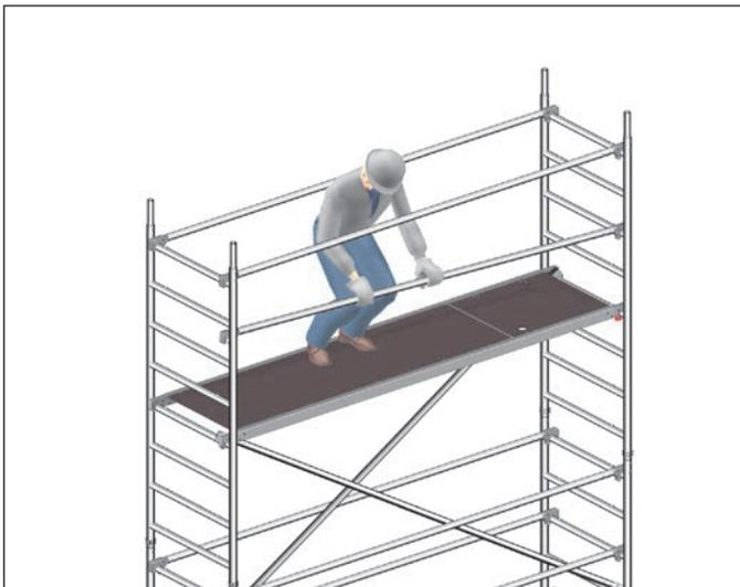
5. Auf die nächste Ebene aufsteigen und zusätzliche Geländer 17 an der zweiten Sprosse über der Standfläche montieren.
