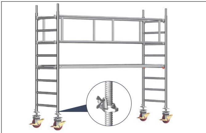
1. Die Lenkrollen 1 werden in die 2,00-m-Standleitern 15 eingesteckt und durch Festdrehen der Flügelschrauben an den Spindelmuttern gegen Herausfallen gesichert.
