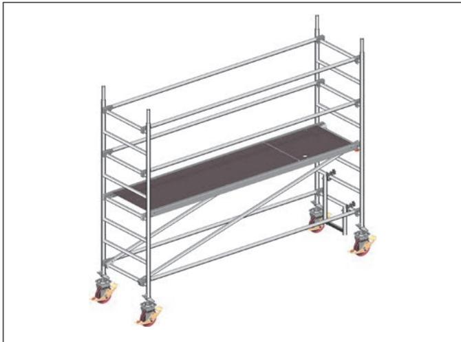
1. Die Lenkrollen **1** werden in die 2,00-m-Standleitern **15** eingesteckt und durch Festdrehen der Flügelschrauben an den Spindelmuttern gegen Herausfallen gesichert.
