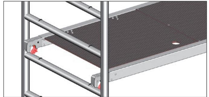
Die **roten/orangen** Schließbügel der Böden ermöglichen, durch ihre speziell dafür gestaltete Geometrie, den mühelosen Ein- und Ausbau durch eine Person; sie sind zuerst zu lösen und der Belag mit den geöffneten Bügeln auf die Sprosse aufzulegen, dann erst werden die gegenüberliegenden Bügel gelöst und der Belag ausgehoben.
