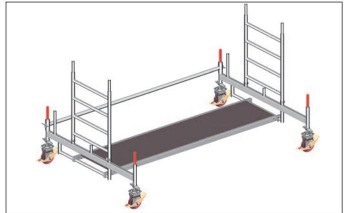
1. Die Lenkrollen 1 in die Fahrbalken 7/8 einstecken und durch Festdrehen der Flügelschrauben an den Spindelmuttern gegen Herausfallen sichern.
