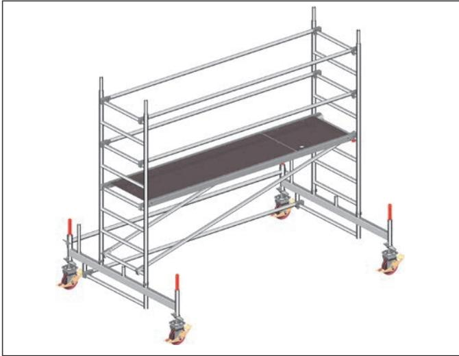
1. Die Lenkrollen 1 in die Fahrbalken 7/8 einstecken und durch Festdrehen der Flügelschrauben an den Spindelmuttern gegen Herausfallen sichern.
