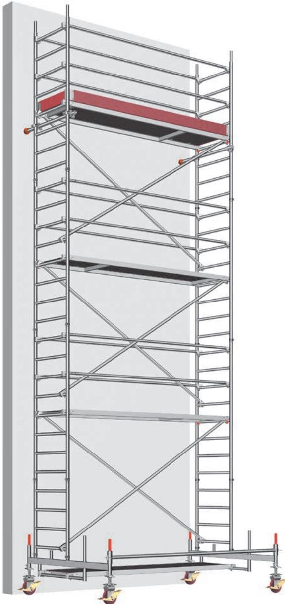
Für Arbeiten, die an einer tragfähigen Wand ausgeführt werden, kann die Ballastierung entsprechend der Tabelle **Ballastierung** (siehe Seite 8 bis 10) reduziert werden. In diesem Fall sind auf beiden Seiten des Gerüsts Wandabstützungen oder Verankerungen einzubauen.
