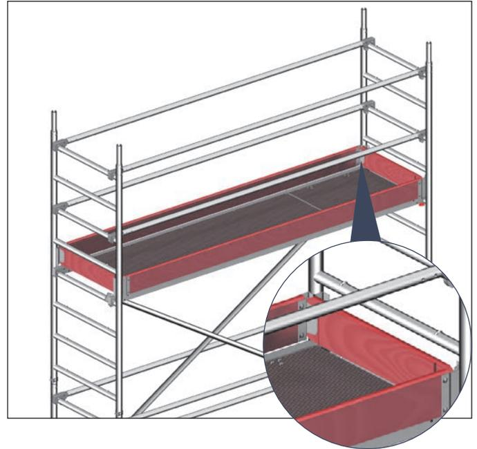
1. Zum Abschluss der Arbeitsbühne müssen Bordbretter mit Klaue 30 und Stirnbordbretter 31 angebracht werden.
