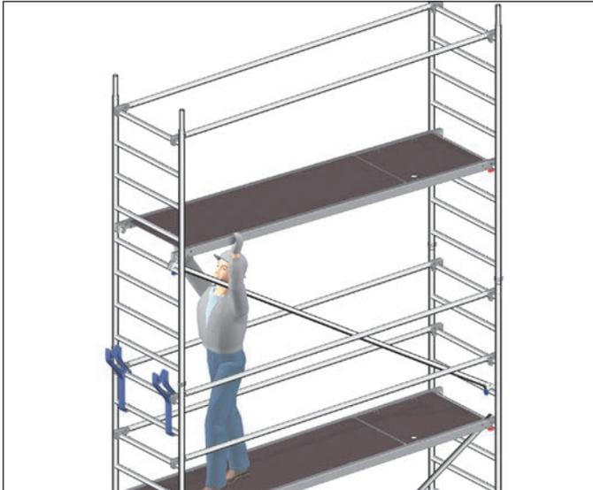
4. Diagonalen 20 und Durchstiegsbrücke 25 einsetzen. Die Diagonalen müssen auf beiden Seiten turmartig (Zick-zack-Form) eingebaut werden.
