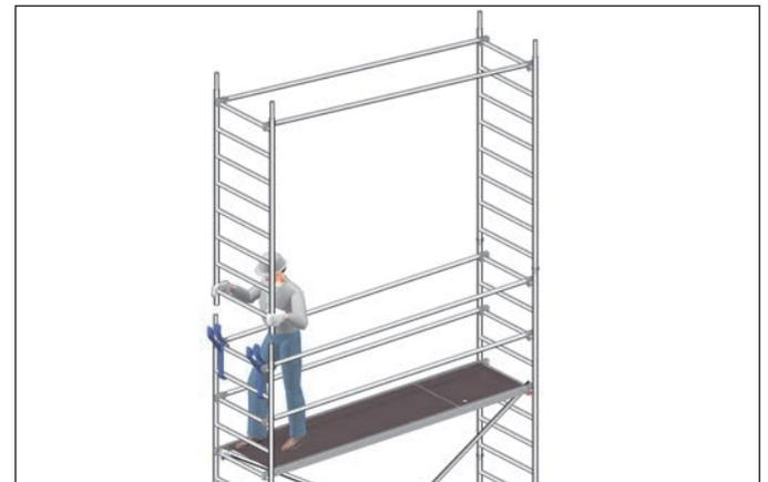
3. Standleiter mit Geländer nach oben schwenken, aufstecken und mit Federsteckern **16** sichern.
