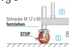
Die Lenkrollen **9** sind im Aufbau und Arbeitszustand durch Drücken des mit STOP gekennzeichneten Bremshebels festzustellen. Im gebremsten Zustand
