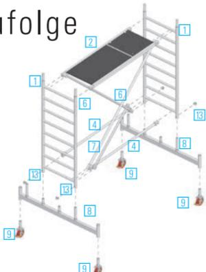
Die Lenkrollen **9** in die Fahrbalken **8** einstecken und durch Schrauben M 12 x 60 mit selbstsichernden Muttern befestigen. Auf die Fahrbalken **8** sind nun die Standleitern **1** aufzustecken und mit Federsteckern **13** zu sichern. Nun werden 2 Diagonalen **6** in die Standleitern **1** eingerastet. Dann sind in der 1. Sprosse von unten der Standleitern **1** 2 Rückenlehnen **4** und ab dem Typ 3204 1 Horizontal-diagonale **7** einzurasten.
