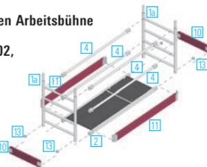
Als erstes wird in die oberste Sprosse der Standleitern **1** eine Durchstiegbrücke **2** eingehängt. Der Aufbau der obersten Arbeitsbühne wird durch Aufstecken der beiden Standleitern **1a** begonnen, die mit Federsteckern **13** gesichert werden. Der Seitenschutz wird mit 4 Rückenlehnen **4** errichtet. 2 Bordbretter 1,8 m **11** zwischen die Standleitern **1a** einstellen und durch Einfügen von 2 Stirnbordbrettern 0,75 **10** sichern.
