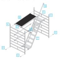
Es müssen beim Aufbau und Abbau Systembeläge oder Gerüstbohlen nach DIN 4420-3 (Mindestabmessung: 28 x 4,5 x 250 cm lang) als Hilfsbeläge im Höhenabstand von max. 2,0 m eingebaut werden. Diese Hilfsbeläge, als sichere Standfläche für den Auf- und Abbau, müssen nach dem Aufbau wieder ausgebaut werden. Die ieweilige Standfläche ist voll auszulegen.
